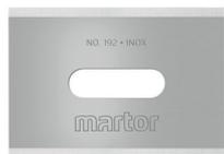
Die INDUSTRIEKLINGE NR. 192 von MARTOR ist eine hochwertige Klinge aus rostfreiem Stahl. Sie ist sehr scharf und verfügt über vier nacheinander nutzbare Schneidkanten für eine besonders lange Einsatzzeit. Die Klinge ist 26 mm lang, 18,5 mm breit und 0,40 mm stark. Das für die Klinge verwendete Öl ist lebensmittelecht.
