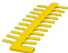
Einsteckschild, Streifen, gelb, unbeschriftet, beschriftbar mit: CMS-P1-PLOTTER, Montageart: aufschieben, Kabeldurchmesserbereich: 0,6 ... 7 mm, Schriftfeldgröße: 10 x 4 mm, Anzahl der Einzelschilder: 20
