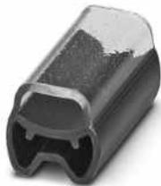
Ader-Bezeichnungsträger, transparent/schwarz, unbeschriftet, Montageart: aufschieben, Kabeldurchmesserbereich: 1,3 ... 2,8 mm, Schriftfeldgröße: 10 x 4 mm
