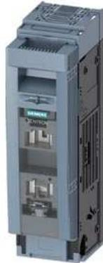
SETRON, Sicherungslasttrennschalter 3NP1, 1-polig, NH2, 400 A, für Aufbau und Einbau auf Montageplatte, Flachanschluss, Abdeckebene 70mm
