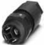
Wanddurchführung mit QUICKON-Schnellanschlusstechnik, zur Aufnahme von einer oder zwei AS-i Flachleitungen, auf der Rückseite mit Handlöt-/ Flachsteckeranschluss 4,8 x 0,8 mm
