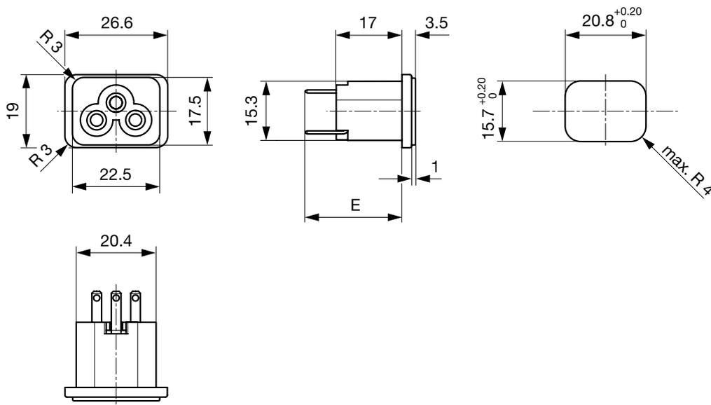
E: Lötanschlüsse kurz: 18.9 mm
