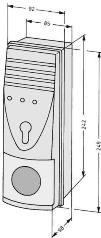
Als Bedienteil in Fluchrichtung in Verbindung mit einer externen Fluchttürsteuerung.
