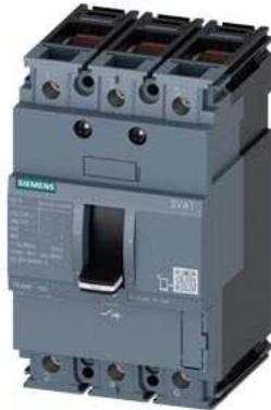
Leistungsschalter 3VA1 IEC Frame 160 Schaltvermögenklasse H Icu=70kA @ 415V 3-polig, Anlagenschutz TM210, FTFM, In=25A Überlastschutz Ir=25A fest eingestellt Kurzschlusschutz Ii=12,8 x In Klemmenanschluss
