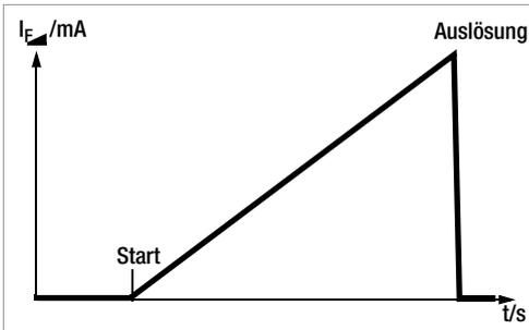
In der Schalterstellung fließt ein langsam ansteigender Gleichstrom über N und PE. Der aktuelle Strommesswert wird hierbei ständig angezeigt. Bei Auslösung des RCD-Schalters
