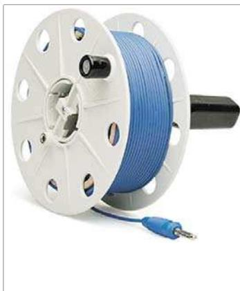
50 m Messleitung, aufgewickelt auf eine Kunststofftrommel. Der Anschluss an das eine Ende der Messleitung ist über eine in die Trommel integrierte Buchse möglich. Das andere Ende ist mit einem Bananenstecker ausgerüstet. Die Trommelachse mit Griff ist steckbar, sodass die Trommel platzsparend aufbewahrt werden kann. Der Widerstandsanteil des Kabels kann in der Schalterstellung  $R_{LO}$  kompensiert werden.
