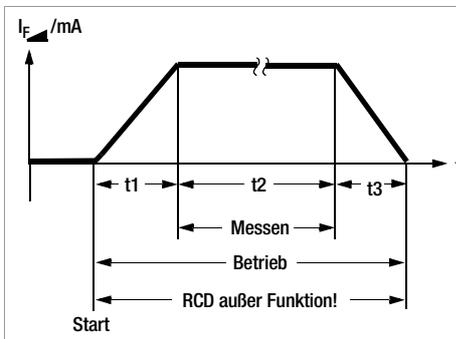
**Spannungsfall-Messung (bei Z<sub>L-N</sub>) – Funktion ΔU**
