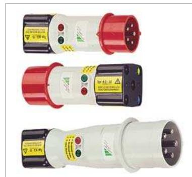
Die Drehstromadapter A3-16, A3-32 und A3-63 dienen dem problemlosen Anschließen von Prüfgeräten an 5-polige CEE-Steckdosen. Die drei Ausführungen unterscheiden sich durch die Größe des Steckers, der jeweils den 5-poligen CEE-Steckdosen mit den Nennströmen 16 A, 32 A, 63 A entspricht. Die Phasenfolge wird jeweils durch Lampen
