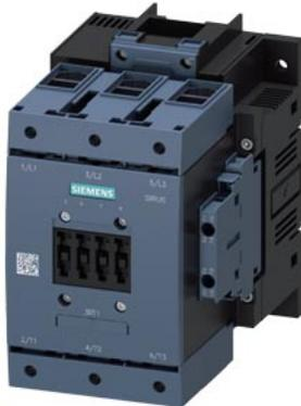
Leistungsschütz, AC-3 115 A, 55 kW / 400 V AC (50-60 Hz) / DC-Betätigung AC/DC 200-220 V Hilfskontakte 2 NO + 2 NC 3-polig, Baugröße S6 mit Rahmenklemmen Antrieb: konventionell Schraubanschluss
