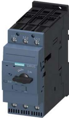
Leistungsschalter Baugröße S2 für Starterkombination Bemessungsstrom 52 A N-Auslöser 741 A Schraubanschluss Standardschaltvermögen
