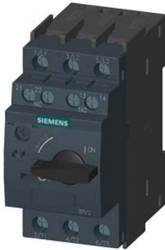
LEISTUNGSSCHALTER BGR. S0, FUER DEN MOTORSCHUTZ, CLASS 10, A-AUSL. 27...32A, N-AUSL. 400A, SCHRAUBANSCHLUSS, STANDARDSCHALTVERMOEGEN, MIT QUERL. HILFSSCHALTER 1S+10E
