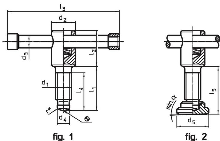
\* per facilitare il montaggio la DIN 6306 è dotata della raggiatura r
