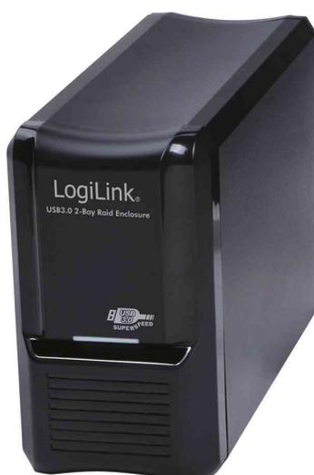
Externes RAID Festplattengehäuse für 2 x 3,5" SATA III Festplatten, Aluminium
