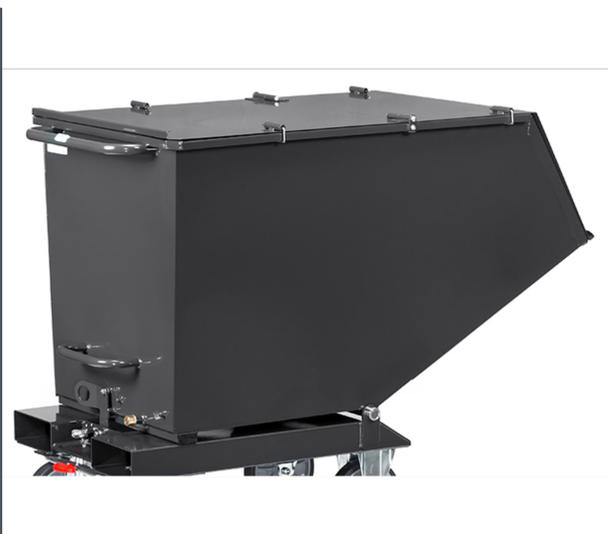
Couvercle rabattable pour benne, ouverture sur 2 parties. Fermeture sécurisée par crochet à ressort. Partie avant peut être verrouillée par crochet à ressort évitant le déversement accidentel. Partie arrière également verrouillable. Gouttière pour bonne prise en main sur partie avant et arrière. Tôle d'acier de 1,5 mm, renforcement interne en fer plat de 15 x 3 mm. Pas d'angles saillants externes. Revêtement époxy Gris Anthracite RAL 7016. Livrable à postériori. Supplément par chariot-benne.
