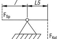
Effektive Spannkraft  $F_{Sp}$  in Abhängigkeit zur Kolbenkraft  $F_{Kol}$  und Spannhebellänge L
