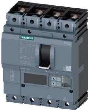
Leistungsschalter 3VA2 IEC Frame 160 Schaltvermögenklasse L Icu=150kA @ 415V 4-polig, Anlagenschutz ETU560, LSIG, In=25A Überlastschutz Ir=10A...25A Kurzschlusschutz Isd=0,6..10x In, li=1,5..12x In N-Leiterschutz einstellbar (OFF, bis 160%) Erdschlusschutz, abschaltbar Ig=0,2...1 x In= tg=0,05-0,8s Schraubenflächenschluss
