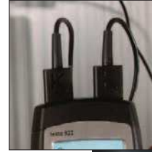
testo 922, gleichzeitige Temperaturerfassung von zwei angeschlossenen Fühlern und Differenz-Temperaturanzeige
