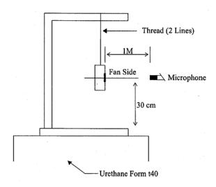
1 METER FROM MICROPHONE TO FAN INTAKE
