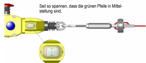
Abb. 3 Spannen des Seils mit Seilmontagesystem ZTK / ZTKE
