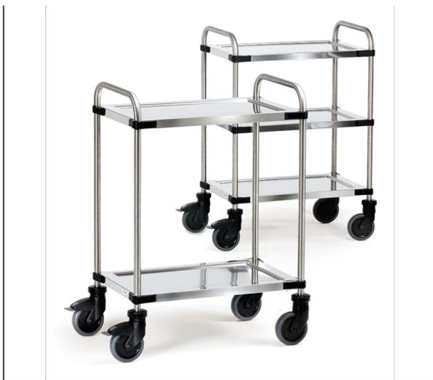
Etagenwagen mit Rohrschiebebügel aus CNS (Chrom-Nickel-Stahl) und 2 tiefgezogenen Böden CS (Chrom-Stahl) mit umlaufendem Rand, schalldämmend unterfüttert. Kantenschutzecken und Abweiserrollen. Rostfreie Rollen gemäß DIN 18867 Teil 8. 4 Lenkrollen mit TPE-Bereifung, elastisch und leicht laufend, spurlos. Naben mit Kugellager, 2 Lenkrollen mit Feststeller gemäß der Europäischen Norm EN 1757-3 (Sicherheit von Plattformwagen). Zerlegte Anlieferung, leichte Selbstmontage. Tragkraft pro Etage 80 kg.
