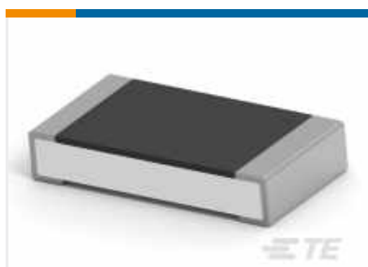
TE Teilnr.:8-2176390-3 RQ 1206 8K25 0.1% 10PPM 5K RL
