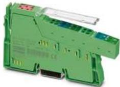
Inline, Digitalausgabeklemme, Digitale Ausgänge: 4, 24 V DC, Anschlusstechnik: 3-Leiter, Übertragungsgeschwindigkeit im Lokalbus: 500 kBit/s, Schutzart: IP20, inklusive Inline-Stecker und Beschriftungsfeld
