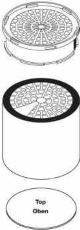
Kompaktfilter, bestehend aus Schwebstofffilter E 12 und Breitbandgasfilter (50 % Aktivkohle, 50% Puratex) für WFE und WFE P
