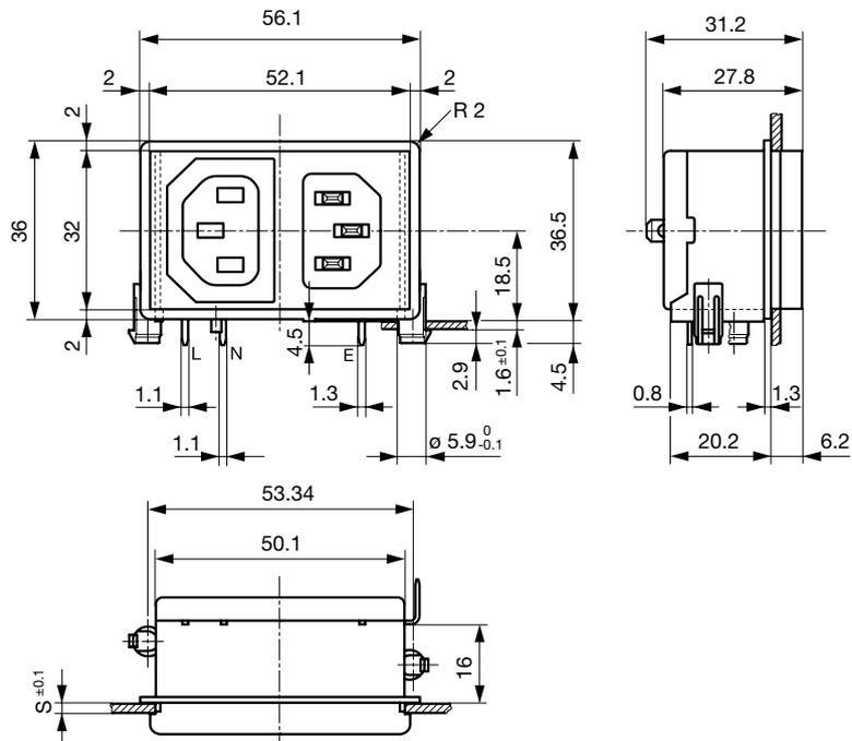
Zusätzlicher Steckanschluss 4.8 x 0.8 mm
