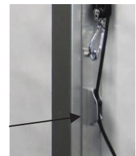
Detail Klemmvorrichtung: Seil am Flaschenzug zum Spannen nach unten ziehen und fixieren
