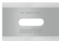
Die INDUSTRIEKLINGE NR. 192043 von MARTOR ist eine hochwertige Klinge aus rostfreiem Stahl. Sie ist sehr scharf und verfügt über vier nacheinander nutzbare Schneidkanten für eine besonders hohe Einsatzzeit. Der Breitschliff erleichtert das Schneiden. Die Klinge ist 26 mm lang, 18,5 mm breit und 0,40 mm stark. Das für die Klinge verwendete Öl ist lebensmittelecht.
