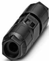
Leitungsverbinder, QUICKON-Anschluss, Polzahl: 3+PE, 0,5 mm<sup>2</sup> ... 1,5 mm<sup>2</sup>, 690 V, 17,5 A, schwarz, mit zwei QUICKON-Muttern, Leitungsaußendurchmesser: 10 mm ... 13 mm, QUICKON-Schnellanschluss
