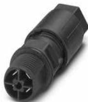
Wanddurchführung, QUICKON-Anschluss, Polzahl: 3+PE, 0,5 mm<sup>2</sup> ... 1,5 mm<sup>2</sup>, 690 V, 15 A, schwarz, mit QUICKON-Mutter, Leitungsaußendurchmesser: 10 mm ... 13 mm, Montagegewinde: M20, Flachsteckanschluss (für Flachsteckhülsen nach DIN 46247-2), 1,5 mm<sup>2</sup>
