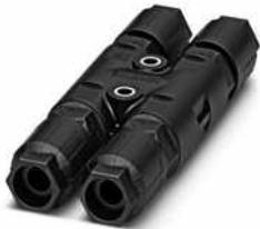
H-Verteiler, QUICKON-Anschluss, Polzahl: 3+PE, 0,5 mm<sup>2</sup> ... 1,5 mm<sup>2</sup>, 690 V, 17,5 A, schwarz, mit QUICKON-Mutter, Leitungsaußendurchmesser: 10 mm ... 13 mm, mit einem Verschlussbolzen
