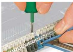
Leiter anschließen/lösen – Serie 256.
