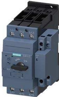
Leistungsschalter Baugröße S2 für den Motorschutz, CLASS 10 mit Überlast-Relaisfunktion A-Auslöser 12...17 A N-Auslöser 260 A Standardschaltvermögen
