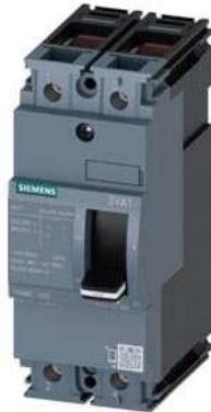
Leistungsschalter 3VA1 IEC Frame 160 Schaltvermögenklasse N Icu=25kA @ 415V 2-polig, Anlagenschutz TM210, FTFM, In=63A Überlastschutz Ir=63A fest eingestellt Kurzschlusschutz Ii=10 x In Klemmenanschluss
