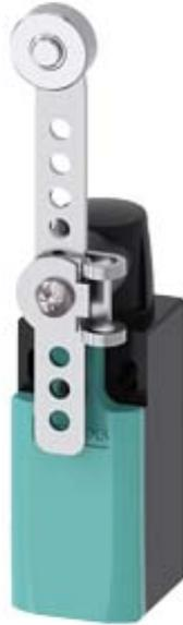
Positionsschalter Kunststoff 31 mm nach DIN EN 50047 erhöhter Korrosionsschutz Geräteanschluss 1 x (M20 x 1,5) 1S/2Ö Sprungkontakte Schwenkhebel längenverstellbar mit Rasterbohrung rechts und/oder links einstellbar, mit Edelstahlhebel und Kunststoffrolle 19 mm funktionsfähig bei -40 °C Schock- und Schwingprüfung nach EN 61373, Kategorie 1B
