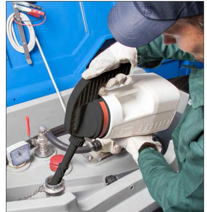
FALCON Abfüllkanne LubriFlex mit langem Auslauf - so ist auch an schwerer erreichbaren Stellen ein sicheres und sauberes Abfüllen gewährleistet.
