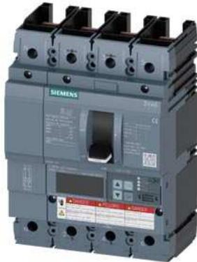
Leistungsschalter 3VA6 UL Frame 150 Schaltvermögenklasse L 150kA @ 480V 4-polig, Anlagenschutz ETU856, LSI, In=100A Überlastschutz Ir=40A...100A Kurzschlusschutz I<sub>sd</sub>=0,6..10x I<sub>n</sub>, I<sub>i</sub>=1,5..12x I<sub>n</sub> N-Leiterschutz einstellbar (OFF, bis 150%) Erdschlussalarm Meldung über EFB300 o. COM ohne Anschluss
