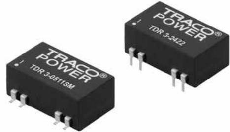
Die DC/DC-Konverter der Serie TDR-3WI bieten 3 Watt Module mit einem ultraweiten 4:1 Eingangsbereich und genau regulierten Ausgängen, auch bei Leerlaufbedingungen. Diese Konverter sind im SMD- oder DIL-Gehäuse lieferbar. Sie arbeiten mit einem hohen Wirkungsgrad über den kompletten Lastbereich und haben eine Extern Ein/Aus-Funktion.
