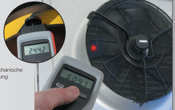
testo 465 und testo 470, berührungslose (optische) Drehzahl-Messung an rotierenden Teilen
