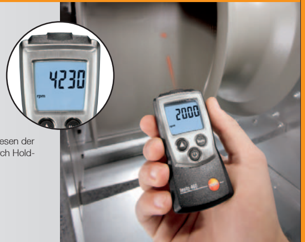
Berührungslose Drehzahlmessung an einem Ventilator
