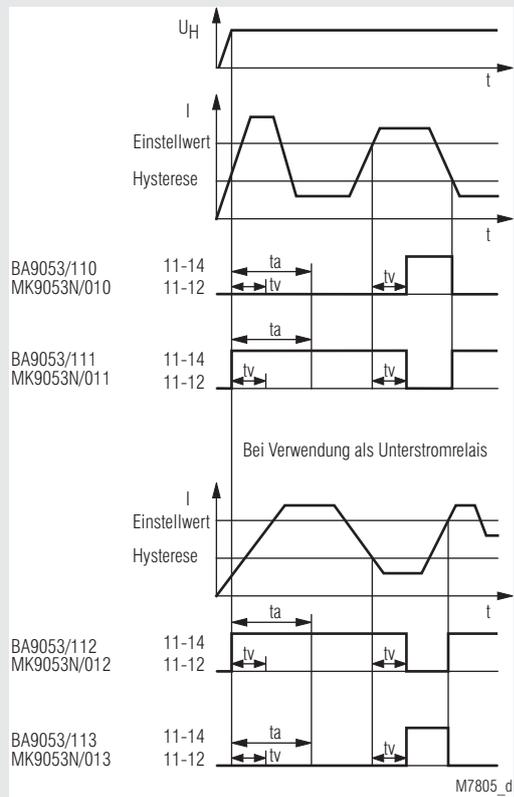
Bei der Ausführung BA 9053/6\_\_ und MK 9053N/6\_\_ mit Fehlerspeicherung wird die Kontaktstellung nach erkanntem Fehler, bzw. nach Ablauf von  $t_v$  gespeichert. Gelöscht wird die Speicherung durch Unterbrechung der Hilfsspannung
