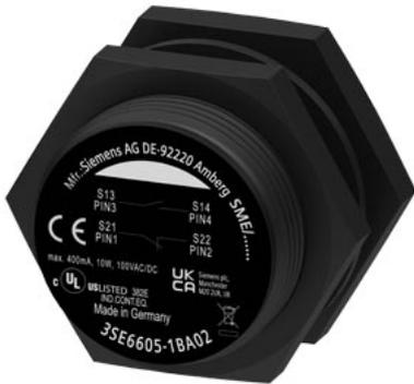
Magnetschalter Schaltelement, rund M30 Schaltglieder 1Ö/1S mit M12 Stecker 4-polig Pin1=21, Pin2=22 Pin3=13, Pin4=14. Erforderlicher Schaltmagnet 3SE6704-1BA. Kupplung mit Anschlusskabel 5m 3SX5601-3SB54
