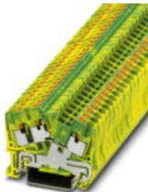
Schutzleiter-Reihenklemme, Anschlussart: Push-in-Anschluss, Querschnitt: 0,14 mm<sup>2</sup> - 4 mm<sup>2</sup>, AWG: 26 - 12, Breite: 5,2 mm, Farbe: grün-gelb, Montageart: NS 35/7,5, NS 35/15
