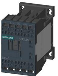
CONT. F. RAILW. A., AC-3, 5.5KW 400V , 1NC, DC 110V, 0.7...1.25\*US, W.SUPPRESSORDIODE INTEGRATED, SZ S00, SPRING-LOADED TERMINAL
