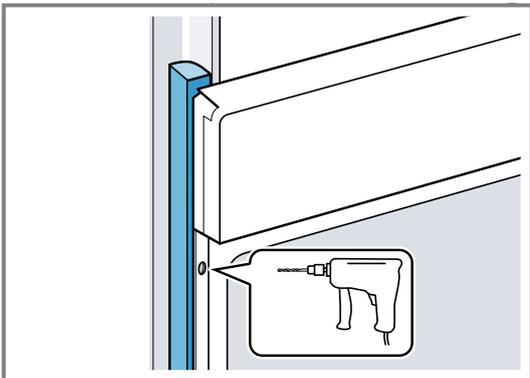
4. Das Gerät mit adäquater Schraube befestigen.
