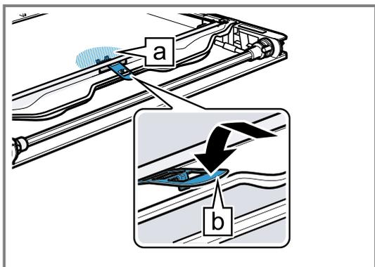
4. Die Innenscheibe an der Gerätetür mittig ausrichten.
