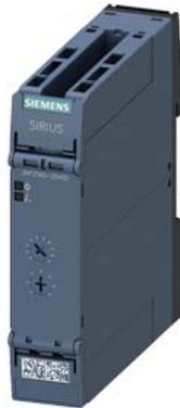
Zeitrelais, elektronisch mit Stern-Dreieck-Funktion 1-20 s, Nachlaufzeit 30-600 s 3 Schließer mit gemeinsamer Wurzel AC/DC 12-240 V bei AC 50/60 Hz mit LED, 0,85 ...1,1 US
