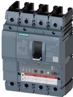
Leistungsschalter 3VA6 UL Frame 150 Schaltvermögenklasse H 65kA @ 480V 4-polig, Anlagenschutz ETU330, LIG, In=40A Überlastschutz, 100% rated Ir=16A...40A Kurzschlusschutz li=1,5...12 x In N-Leiterschutz einstellbar (OFF, 100%) Erdschlusschutz Ig=0,375...1 x In= tg=0,1/0,3s ohne Anschluss
