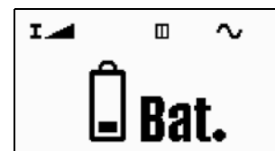
Figura 3.9 Simbolo di batteria scarica quando si preme START
