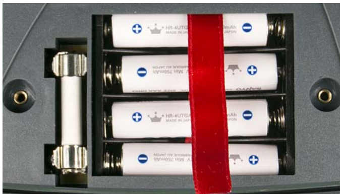
Figura 5 Polarità corretta delle batterie
