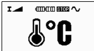
Figura 3.11 Allarme di temperatura quando si preme START
