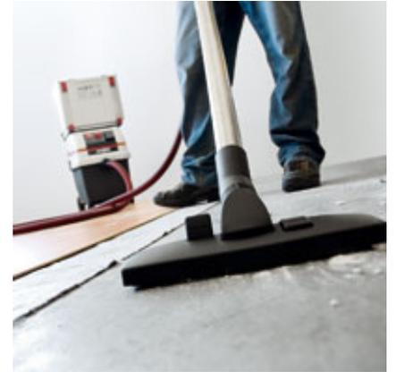
Grundlage für sauberes Arbeiten, ein MAFELL-Absauggerät mit Handabsaugset.
