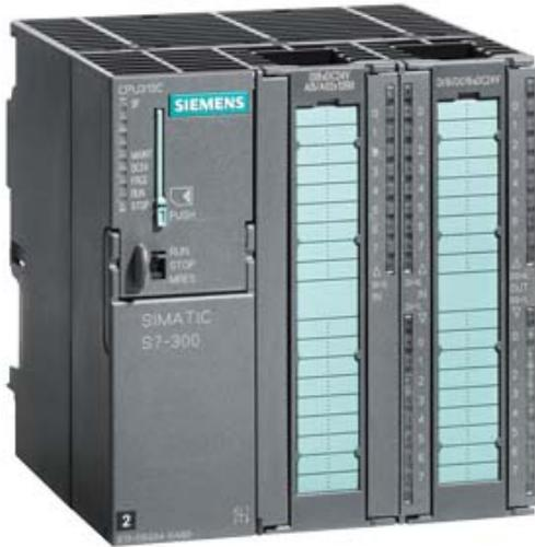
SIMATIC S7-300, CPU 313C, KOMPAKT CPU MIT MPI, 24 DE/16 DA, 4AE, 2AA, 1 PT100, 3 SCHNELLE ZAEHLER (30 KHZ), INTEGR. STROMVERSORGUNG DC 24V, ARBEITSSPEICHER 128 KBYTE, FRONTSTECKER (2 X 40POLIG) UND MICRO MEMORY CARD ERFORDERLICH
