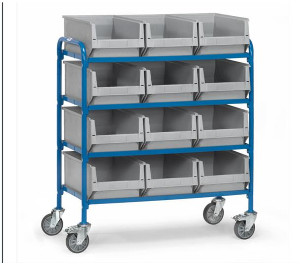
Baukasten-System: Stahlrohr- und Profilstahl geschweißt, pulverbeschichtet blau RAL 5007, Schraubkonstruktion. 4 Etagen mit Holzwerkstoffplatten, Rand 10 mm hoch und 12 Sichtlagerkästen (LxBxH: 500/450 x 310 x 200 mm). Tragkraft pro Ladefläche 60 kg. 4 Lenkrollen, TPE-Bereifung, Naben mit Rillenkugellager. 2 Stück mit Feststeller, gemäß der Europäischen Norm EN 1757-3 (Sicherheit von Plattformwagen). Zerlegte Anlieferung.
