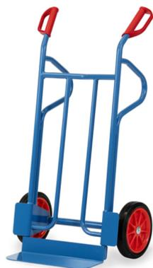
Ensemble mécano-soudé en tube et tôle d'acier, revêtement époxy bleu RAL 5007. Poignées de sécurité en plastique dur avec arceaux de sécurité. Bavette en tôle d'acier à boulonner et remplaçable. Roues à bandage caoutchouc, moyeu à roulement à rouleaux. Livré avec bavette démontée.
