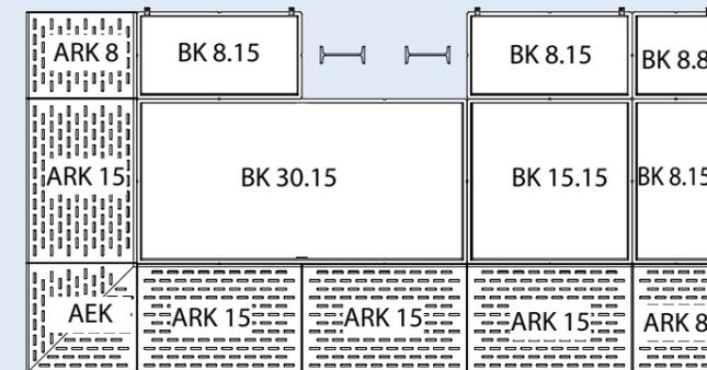
Die unterschiedlichen Grundmaße der Bodenelemente erlauben beispielsweise auch die Umbauung von Pfeilern und Stützen.
