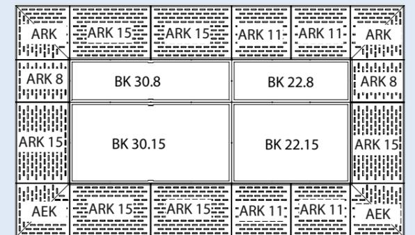
Zu jedem Bodenelement passende Rampen ermöglichen eine Rundum-Befahrbarkeit der kompletten Lagerfläche.
