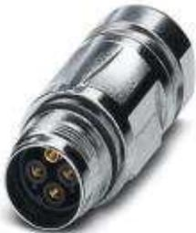
Kupplungssteckverbinder, gerade, für Standard- und SPEEDCON-Verriegelung, M17, Polzahl: 5+3+PE, Kontaktart: Buchse, Crimpanschluss, geschirmt: ja, Kabeldurchmesserbereich: 10 mm ... 12,5 mm
