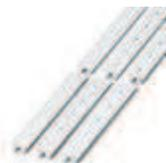
Marker für Klemmen, Streifen, weiß, beschriftet, längs bedruckt: L1, L2, L3, N, PE, Montageart: Verrasten in hoher Schildchennut, für Klemmenbreite: 15,2 mm, Schriftfeldgröße: 10,5 x 15,1 mm
