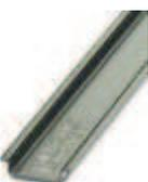
Tragschiene, Material: Stahl, ungelocht, Höhe 7,5 mm, Breite 35 mm, Länge: 2 m
