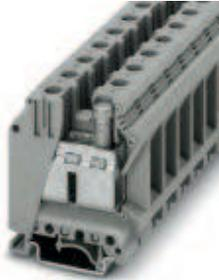
Durchgangsklemme, Anschlussart: Schraubanschluss, Querschnitt: 0,75 mm<sup>2</sup> - 50 mm<sup>2</sup>, AWG: 18 - 1/0, Breite: 15,1 mm, Farbe: grau, Montageart: NS 35/7,5, NS 35/15, NS 32
